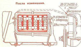
Рис. 1. Установка аккумуляторной батареи.
